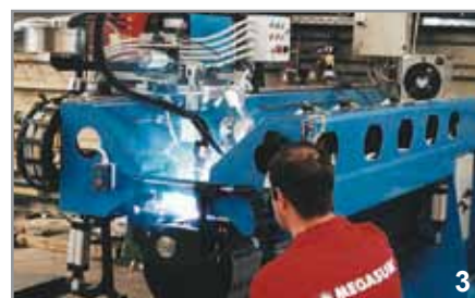
Ρομπότ οριζόντιας συγκόλλησης των δεξαμενών.
