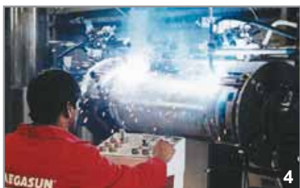
Ρομπότ περιμετρικής συγκόλλησης των δεξαμενών.
