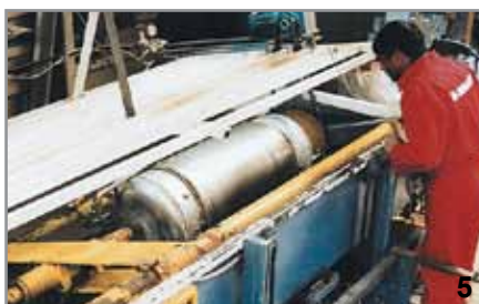
Συγκρότημα δοκιμής πίεσης των δεξαμενών.
