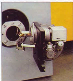
Στήριξη καυστήρα για εύκολη συντήρηση
